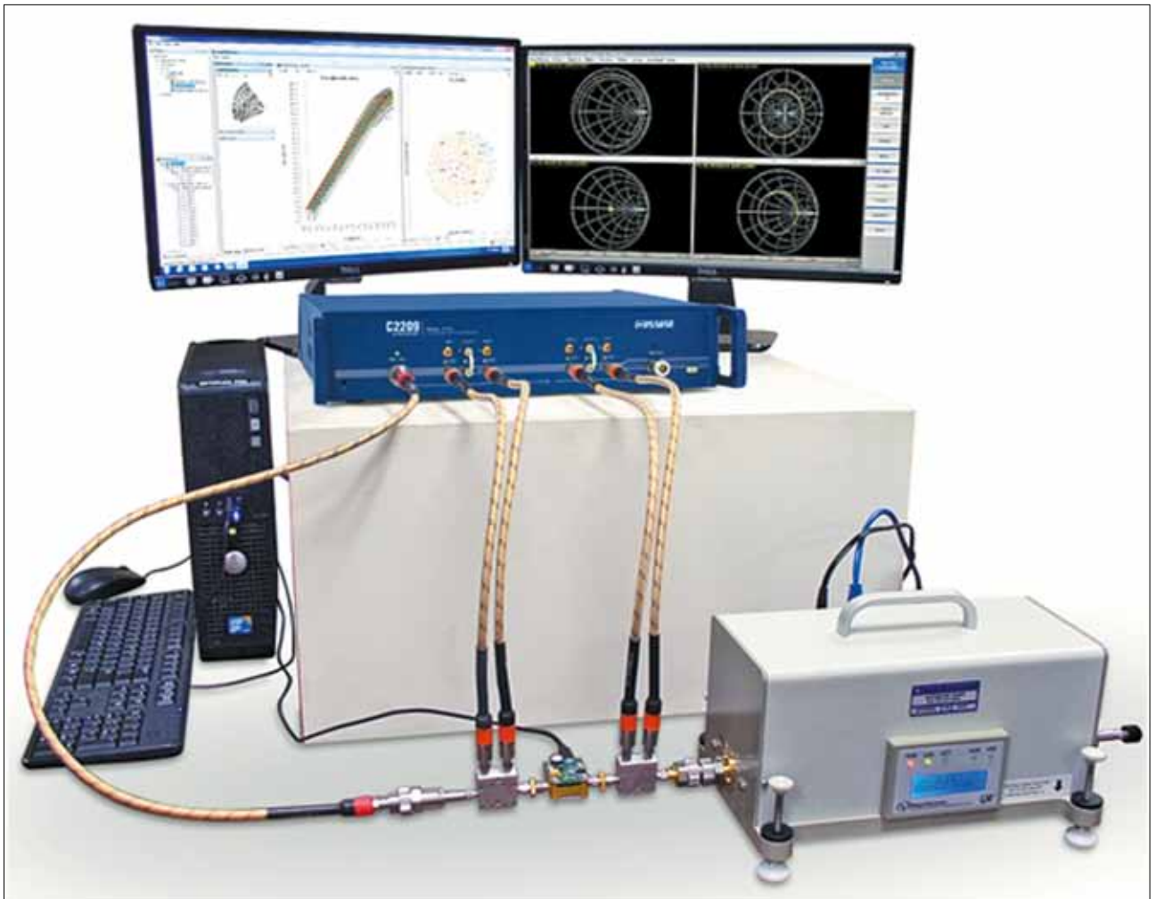
▲ Рис. 5. Измерительная система с переменным импедансом
