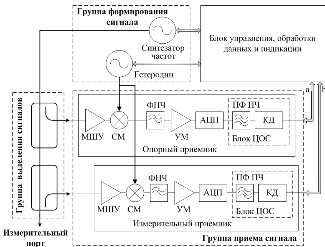
Рисунок 1 – Структурная схема ВАЦ (рефлектометра)
