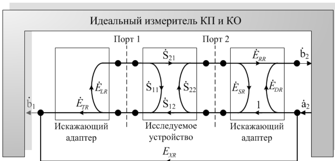
Рисунок 13 – Модель ВАЦ при прямом направлении зондирования
